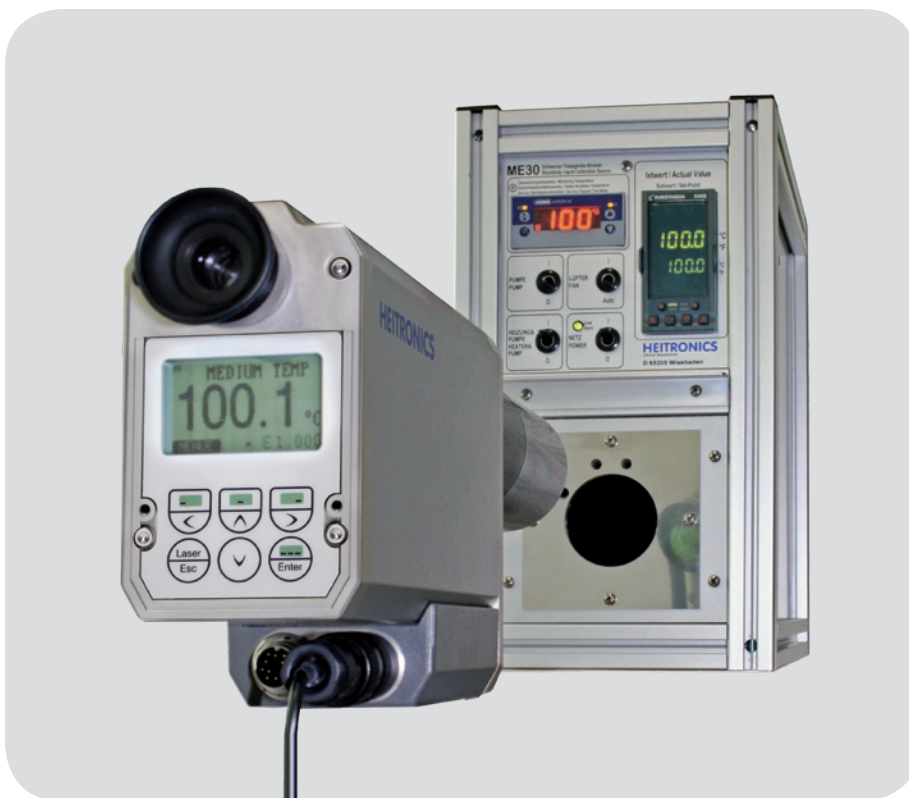
Bild 2: Kalibrierung des ME30 mit Transfer-Strahlungs-Thermometer (TRT)
